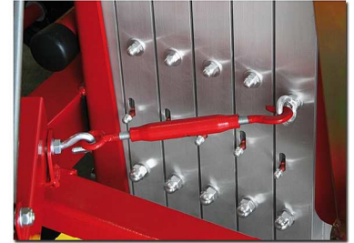
Sistema ajustable de bloqueo de los perfiles para el transporte en horizontal.
